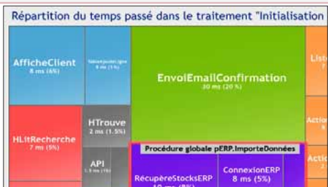
Le profiler affiche les durées d'exécution constatées des traitements
